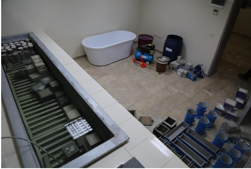
Beton kürleme odası.
